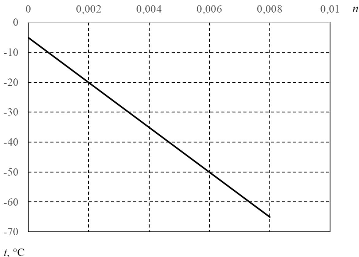
**14.** Автомобиль потратил половину бака, а затем долил «летнее» топливо. Концентрация антигеля при этом понизилась в 2 раза:  $\frac{n_2}{n_3} = \frac{\Delta t_2}{\Delta t_3} = 2$ . Значит,  $\Delta t_3 = -30^\circ\text{C}$ , а новая температура гелезирования  $t_3 = -35^\circ\text{C}$ . Аналогичный вывод можно было сделать, пользуясь графиком.
