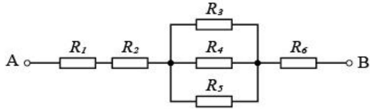
Определите величину общего сопротивления участка АВ ( $R$ ).  $R_1 = 2$  Ом,  $R_2 = 2$  Ом,  $R_3 = R_4 = R_5 = 1$  Ом,  $R_6 = 3$  Ом. Ответ выразите в омах, округлив результат до десятых.
