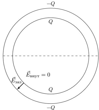
электрическим полем внутри плоского конденсатора, поскольку поверхностные плотности заряда на полусферах по модулю практически совпадают. Отсюда:
