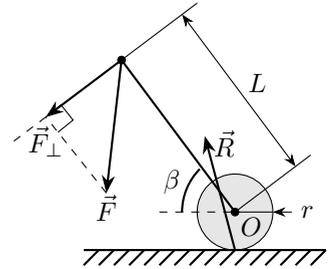
Запишем закон сохранения энергии. Кинетическая энергия тела в этой системе отсчета стремится к нулю, так как центр шайбы неподвижен, ее размер мал, а стержень невесомый. Тогда суммарная работа всех сил, а как следствие и суммарная мощность, равна нулю.
