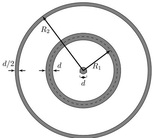
дельных лучей 3 и 4 видно, что толщина второго кольца  $d_2 = d/2$ , а радиус внешней части второго кольца равен  $R_2 = L \operatorname{tg} \alpha_2 = 6dL/h$ .
