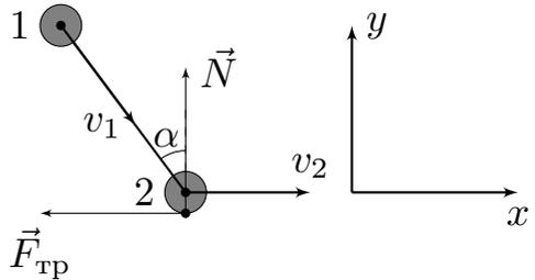
Компонента скорости шайбы 2, направленная перпендикулярно стержню, равна  $v_{\perp} = v_2 \cos \alpha$ , поэтому для угловой скорости вращения стержня имеем:
