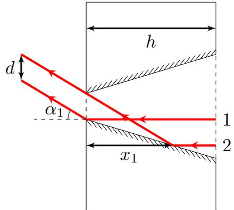
света и конической поверхностью отверстия. Из геометрии  $\alpha_0 = (D - d)/2h = 3d/2h$ . Заметим, что из условия следует  $\alpha_0 \ll 1$ .
