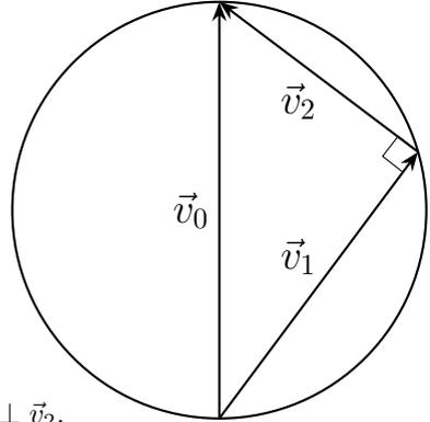
Поскольку  $v_1^2 + v_2^2 = v_0^2$  и  $\vec{v}_0 = \vec{v}_1 + \vec{v}_2$ , то треугольник скоростей является прямоугольным и вписан окружность с диаметром  $v_0$ .
