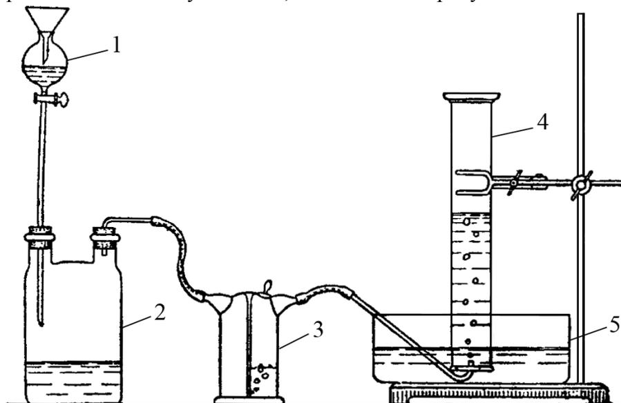
В капельную воронку 1 налили бром, в двугорлую склянку 2 – крепкий раствор аммиака, в промывную склянку 3 – воду. Цилиндр 4 наполнили водой и опрокинули в кристаллизатор 5.
