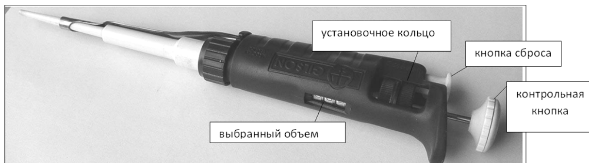
Рис. Устройство автоматической пипетки.
