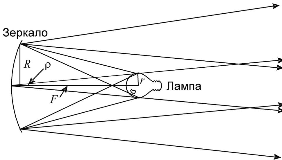
Здесь  $F$  – расстояние от лампы до отражателя, оно же – фокусное расстояние отражателя. Лампа располагается в фокусе отражателя, и каждая часть лампы создает на выходе параллельный пучок света. За счет того, что лампа имеет конечные размеры, весь выходящий поток света будет иметь вид расходящегося конуса, стороны которого будут образовывать угол с осью, равный угловому радиусу лампы, видимой от отражателя:
